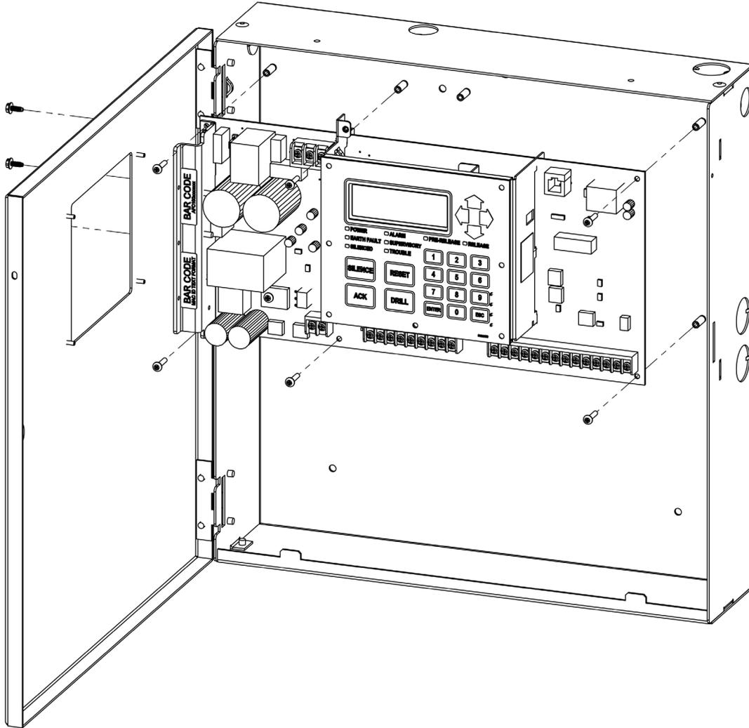
Figure 40. Gabinete IPA-100 mostrando montagem da placa de circuito
