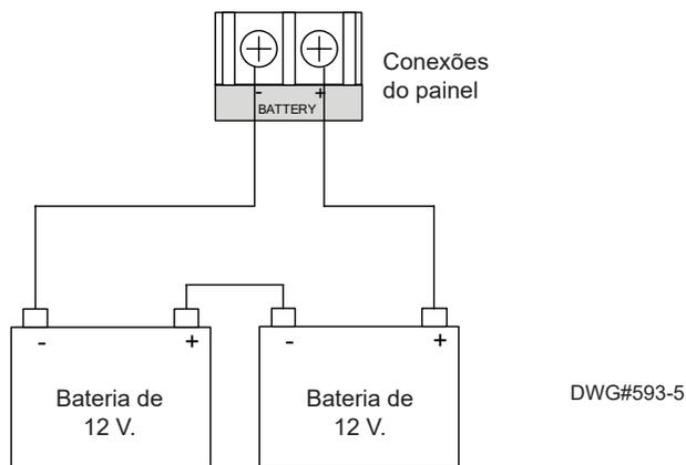
Figure 3. Conexões do circuito da bateria
