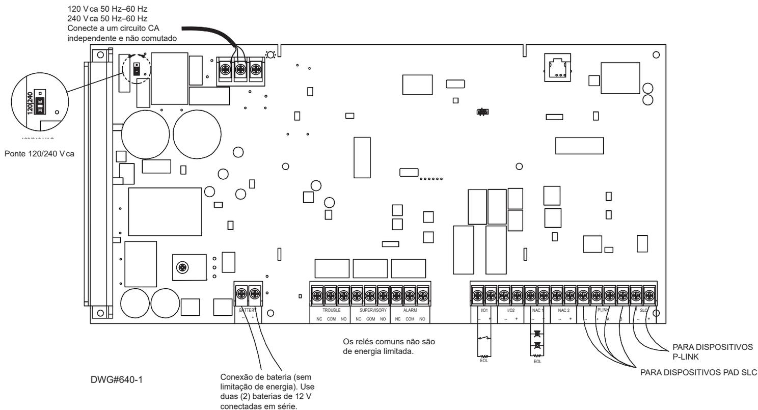
Figure 1. Esquema elétrico do painel de incêndio endereçável IPA-100
