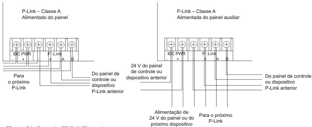
Figure 36. Conexão IDC-6 Classe A
