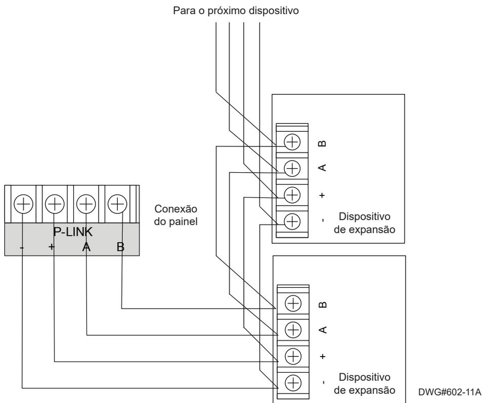
Figure 14. Exemplo de fiação Classe B do P-Link
