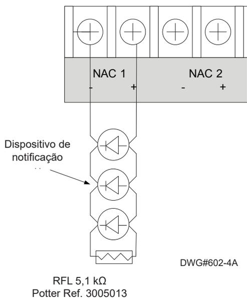
Figure 4. Conexão NAC Classe B
