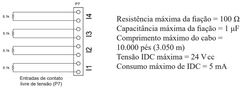
Figure 27. Conector de entrada "P7" com contatos livres de tensão DRV-50
