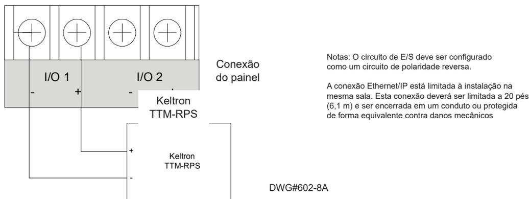
Figure 18. Exemplo de fiação de circuito de E/S de polaridade reversa
