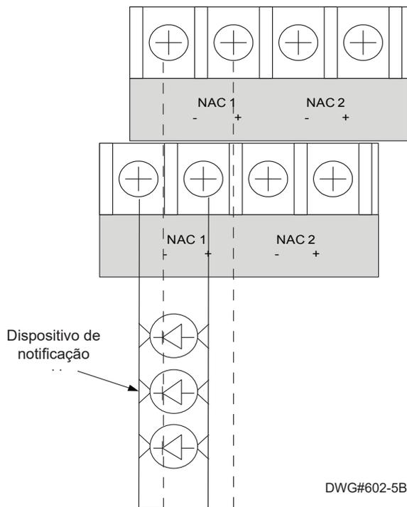
Figure 5. A fiação NAC Classe A requer CA-6075
