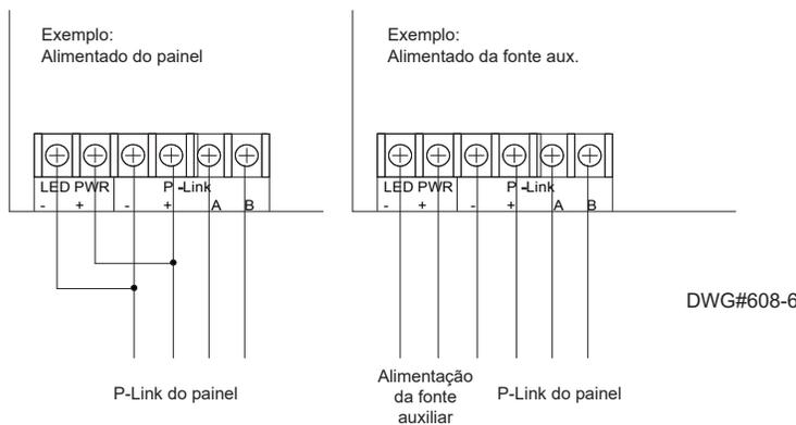
Figure 28. Exemplos de conexão do DRV-50 a partir do painel de controle ou fonte de alimentação auxiliar
