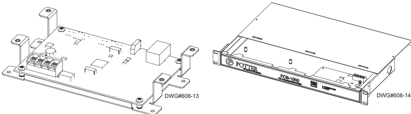
Figure 31. Ponte FCB-1000 e FCB-1000RM mostrando montagem em rack
