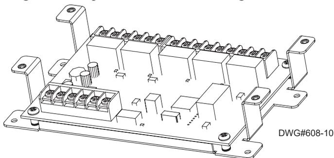
Figure 29. Placa RLY-5 mostrando o suporte de montagem
