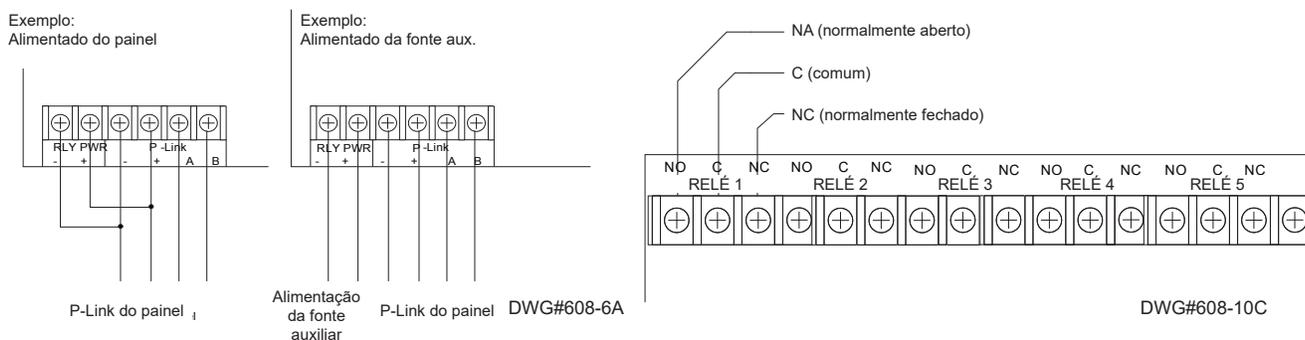
Figure 30. Conexão do RLY-5 ao painel de controle/fonte de alimentação auxiliar e aos contatos normalmente abertos/normalmente fechados do RLY-5
