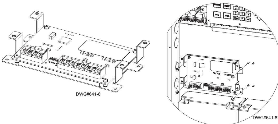
Figure 34. São mostradas a placa MC-1000 Multi-Connect e o MC-1000 instalados no gabinete IPA-4000.
