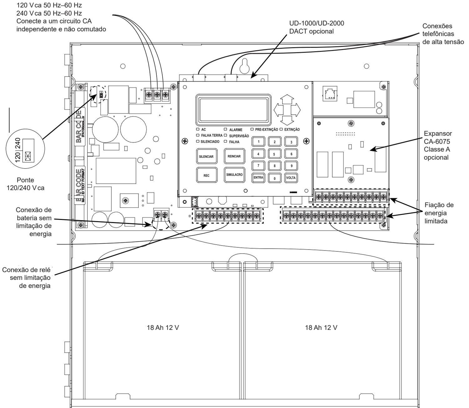
Figure 20. Exemplo de roteamento de cabos do painel de controle
